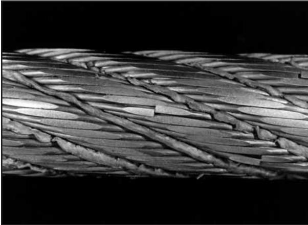
Bild 9: Die seitlich in entgegengesetzte Richtungen weggedrehten Drahtbrüchen weisen auf Seilverdehnung hin.
