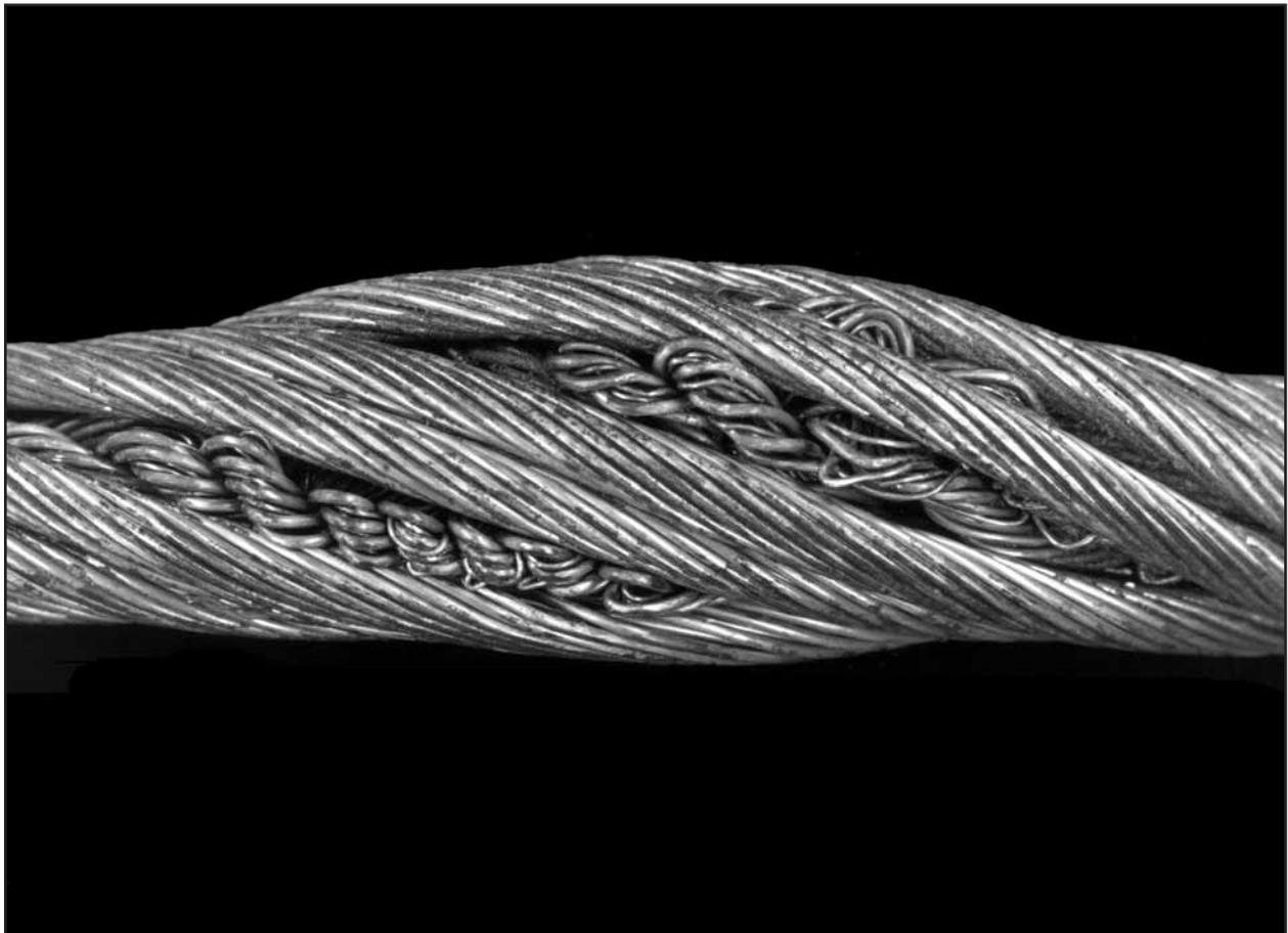
Bild 97: Die durch Verdrehung des Seiles erzeugte Überlänge der Litzen in der Stahleinlage wurde von einer Seilscheibe zu einem Punkt hin massiert. Derartige Schäden finden sich üblicherweise am Endpunkt der Bewegung des Seiles über eine Scheibe oder eine Trommel.
