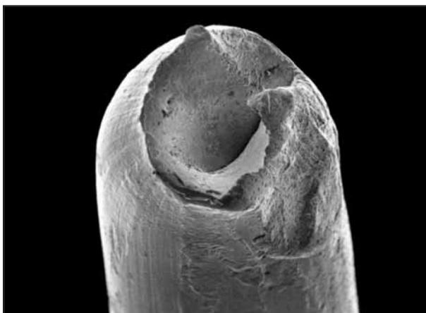
Bild. 39: Dieser lokal vorgeschädigte Draht versagte zuletzt durch Überlast.
