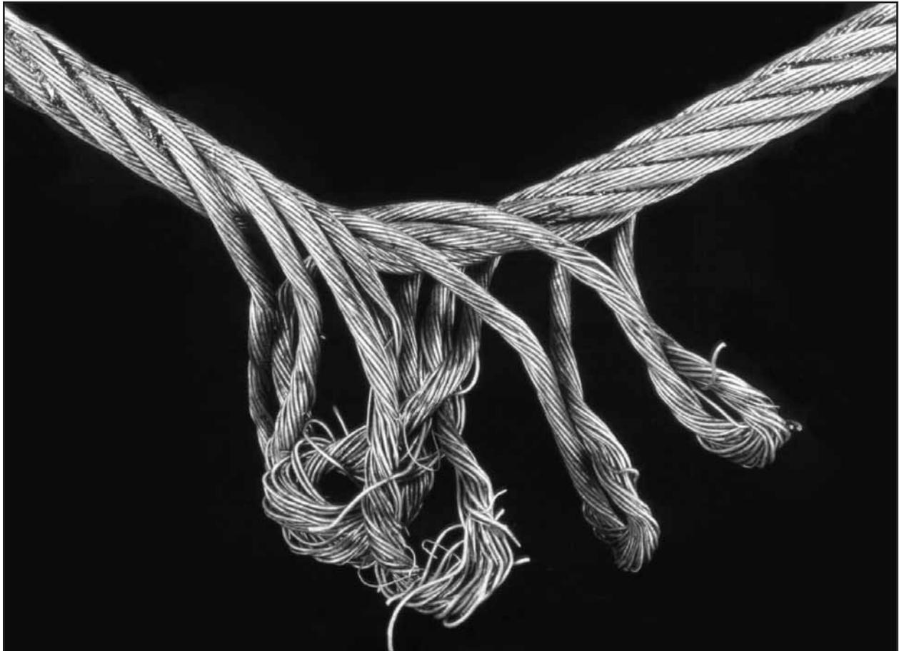
Bild 107: Dieses Drahtseil wurde aufgedreht. In diesem Zustand sind die Außenlitzen zu lang für das Seil. Eine Seilscheibe hat die Überlängen zu einem Punkt hin massiert, wo die Außenlitzen nun hochstehen.
