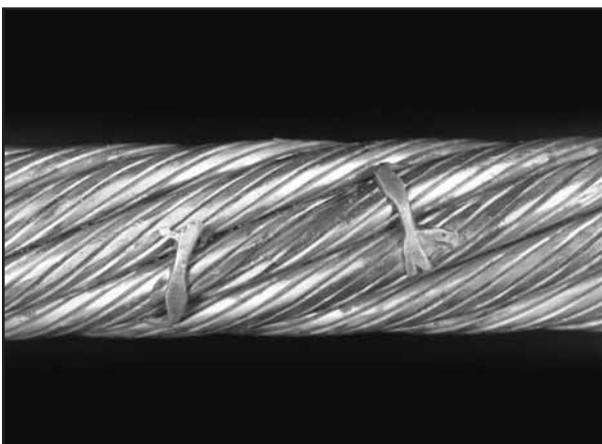
Bild 116: Diese zwei gebrochenen Drähte kamen zwischen Seil und Seilscheibe zu liegen und wurden stark abgeflacht.
