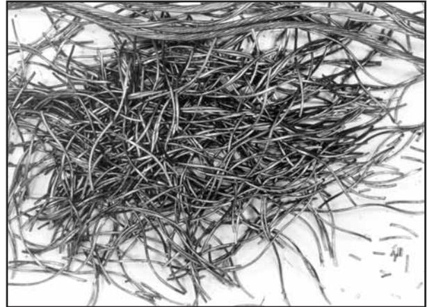
Bild 85: Beim Öffnen dieses abgelegten Drahtseiles konnte festgestellt werden, daß die Stahlseele nicht mehr sehr gut erhalten war.
