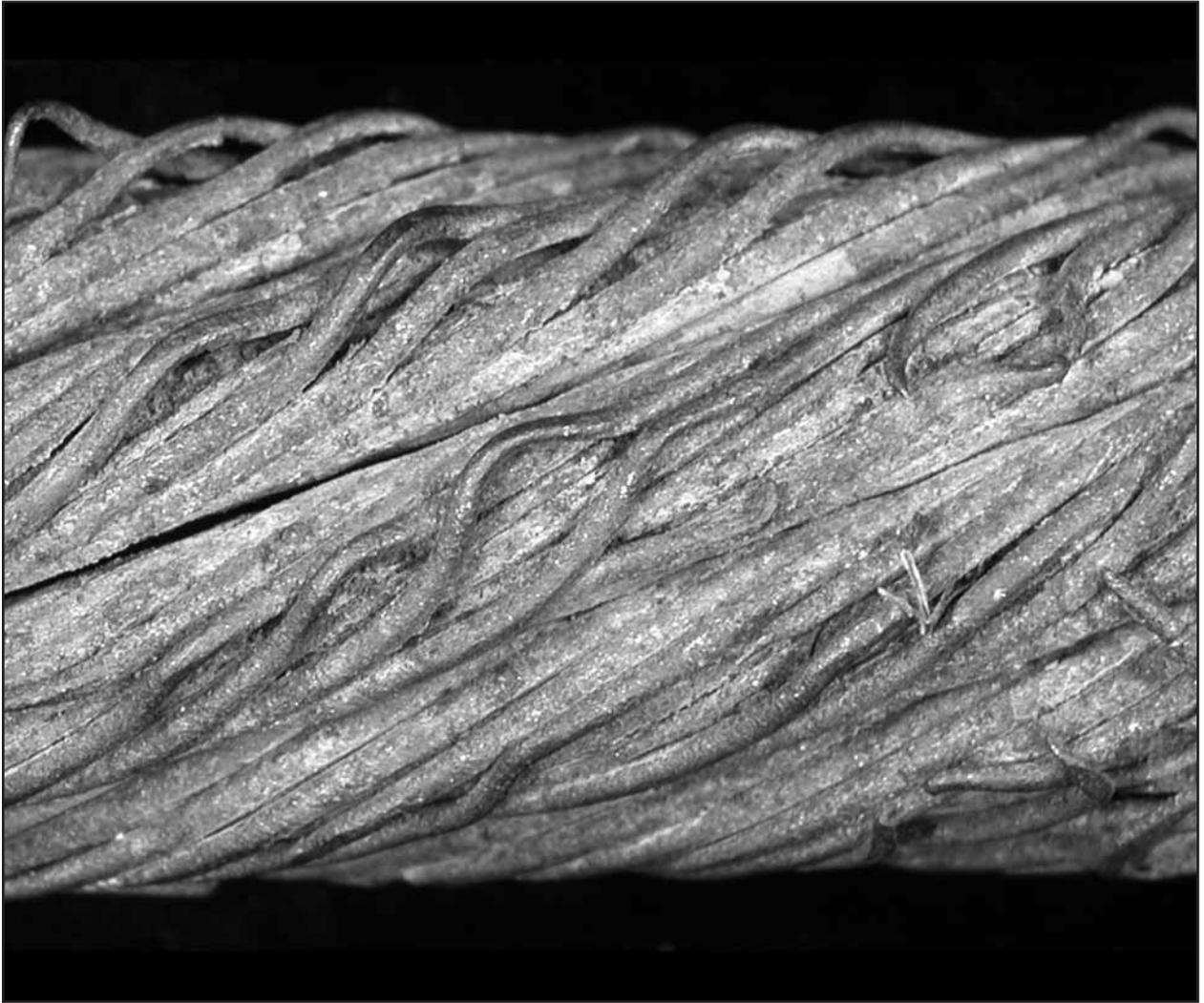
Bild 80: Dieses Hubseil eines Gießkranes war zu lange erhöhten Temperaturen ausgesetzt gewesen. Die Aussendrähte wurden ausgeglüht und längten sich anschließend im Betrieb.
