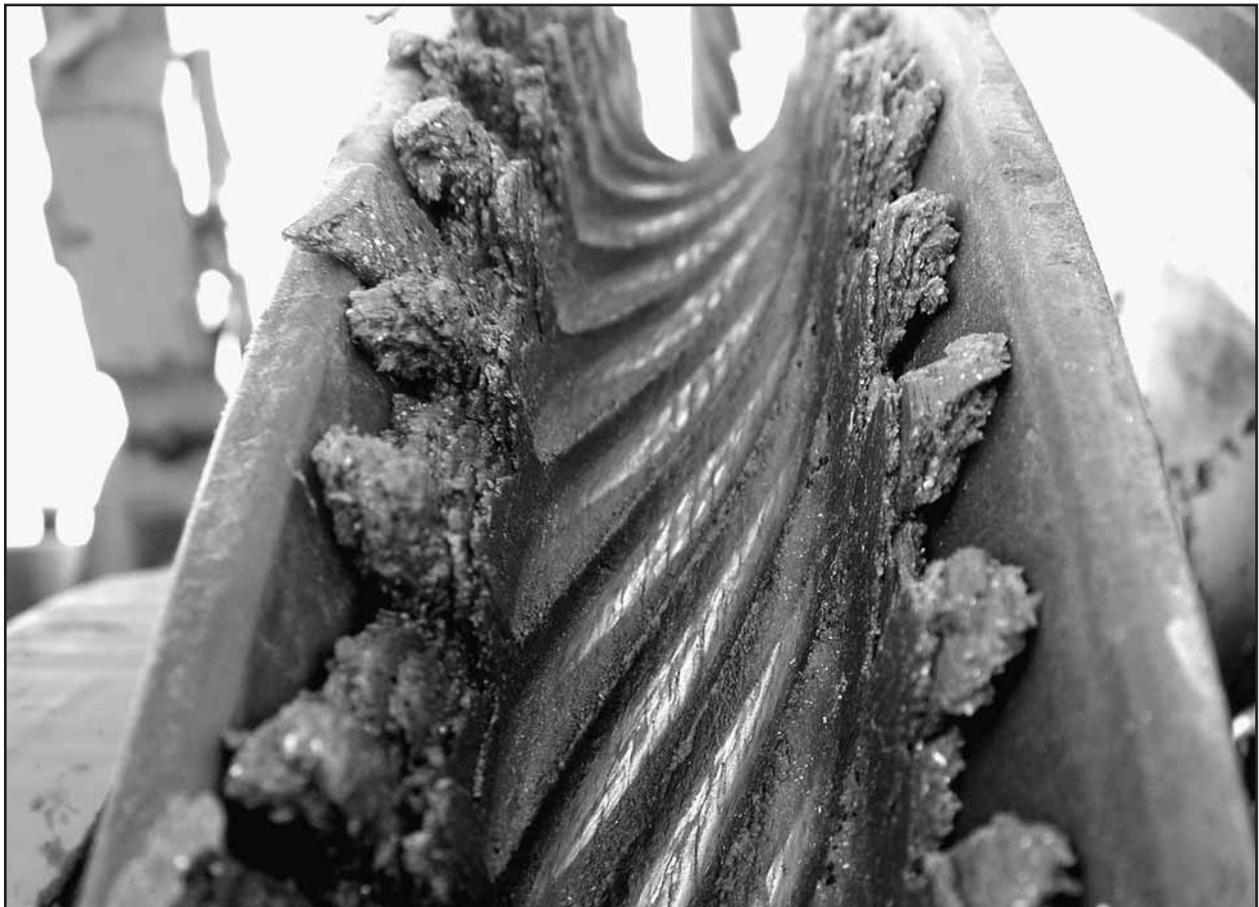
Bild 118: Schmiermittelablagerungen auf den Rillenflanken in regelmäßigen Abständen deuten im Gegensatz zu kontinuierlichen Ablagerungen auf, die Entstehung von Negativabdrücken hin.
