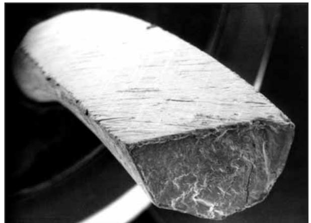
Bild 21: Draht mit starkem Abrieb und Ermüdungsbruch.
