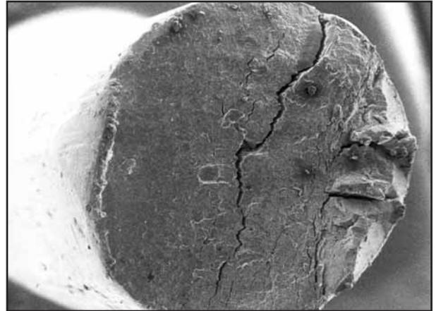
Bild 19: Ermüdungsdrahtbruch.
