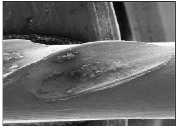
Bild 94: Überkreuzungsstellen zwischen zwei Litzenlagen sind oft die Ausgangsorte für Ermüdungsdrahtbrüche im Seilinneren.
