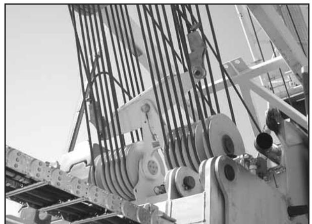
Bild 147: Bei paarweise arbeitenden Seilen führen kleine Differenzen im Seildurchmesser zu großen Unterschieden in der gespulten Seillänge.
