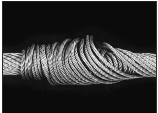
Bild 110: Eine weitere Korbbildung an einem drehungsarmen Seil.
