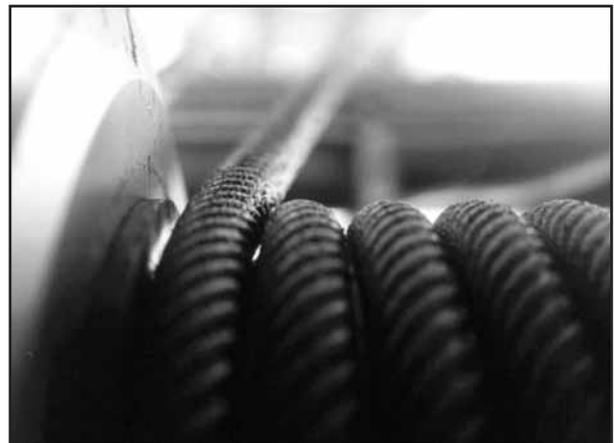
Bild 128: Der Ablenkwinkel drückt den auflaufenden Seilstrang gegen die Nachbarwindung und erzeugt starken Abrieb und Seilverdrehung.
