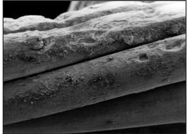
Bild 29: Pittingbildung (lokaler Korrosionsangriff, der tiefe Löcher oder „pits“ erzeugt).
