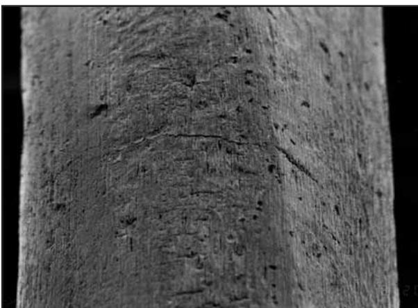
Bild 13: Oberflchenkorrosion begnstigt oft die Entstehung von Ermdungsrisse.
