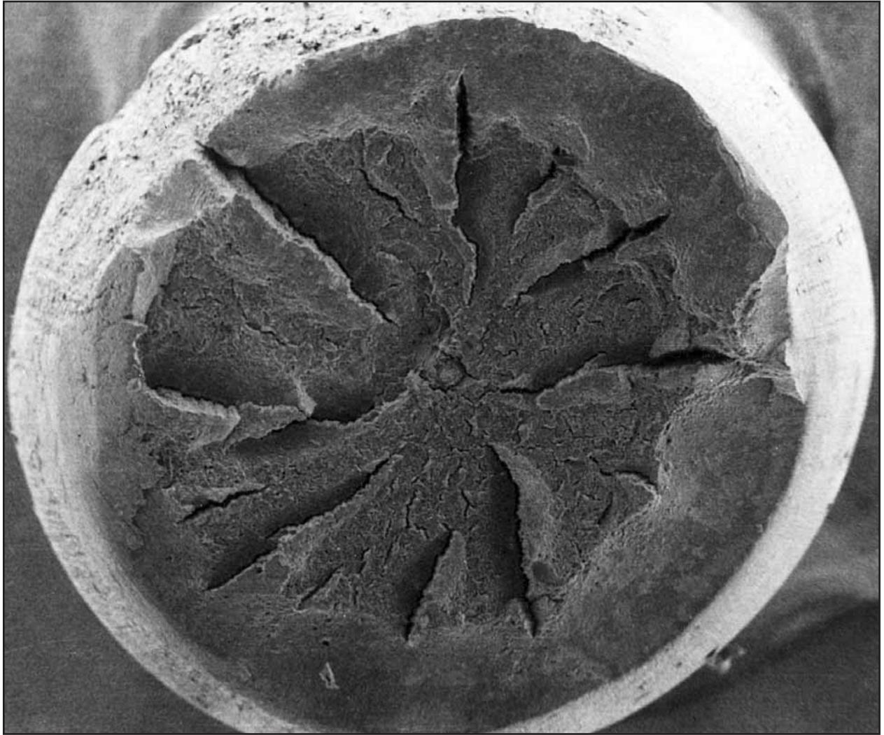
Bild 41: Blick senkrecht auf die Bruchfläche eines Überlastbruchs. Der innere Konus versagt typischerweise infolge Zugspannung, der äußere Ring (durch die Kombination von Zug- und Druckspannung als Folge der Einschnürung) als Scherbruch.
