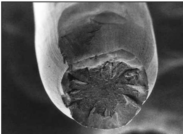
Bild 37: Überlastbruch mit deutlicher Brucheinschnürung an einer Drahtüberkreuzungsstelle.
