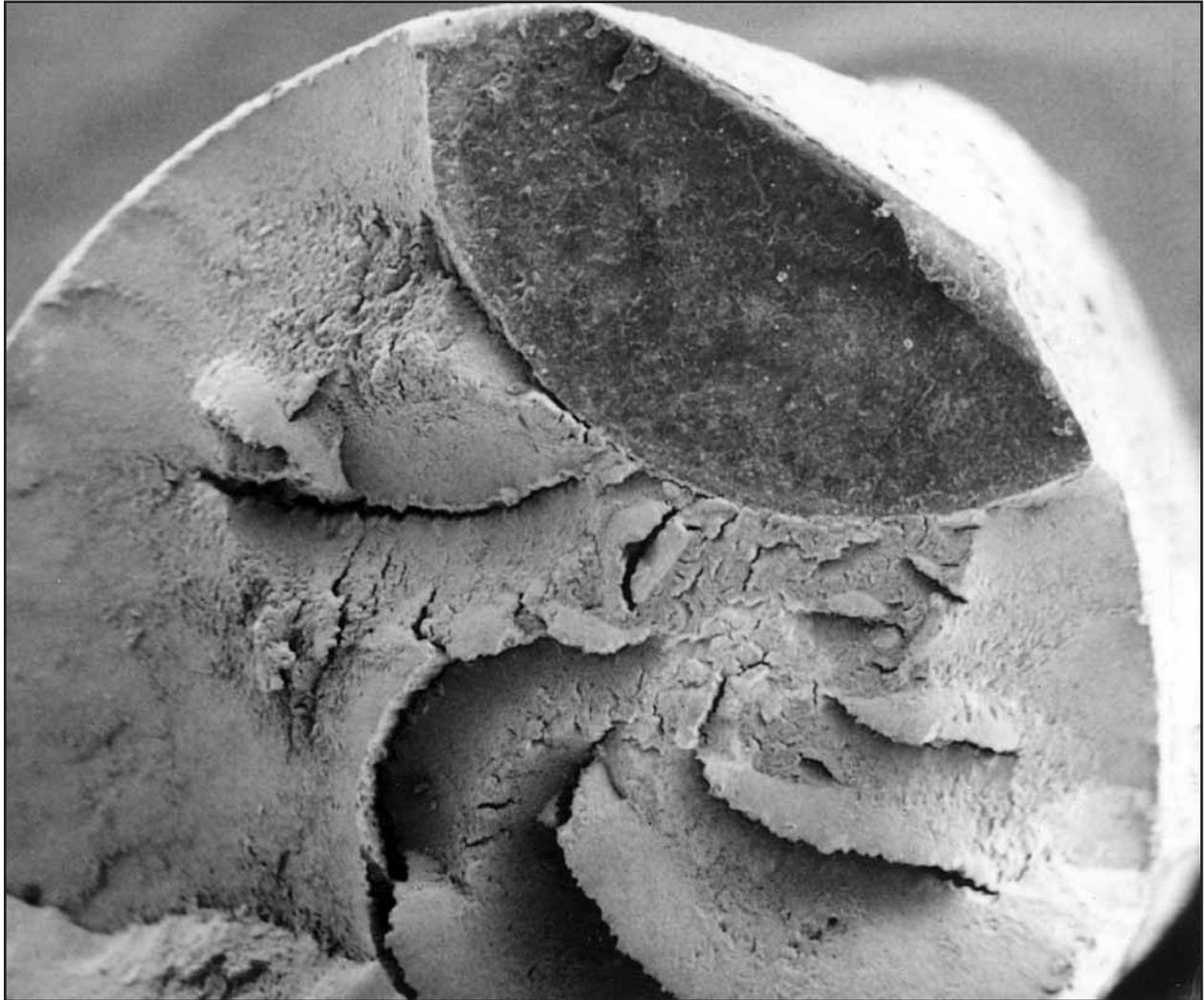
Bild 15: Ein Ermüdungsriß hat sich an der Kontaktstelle des Drahtes mit der Seilscheibe gebildet. Offensichtlich hat sich der Riß konzentrisch zu seinem Ausgangspunkt vergrößert. Der Riß wurde erst nach der Zerstörung des Drahtes im Zugversuch sichtbar.
