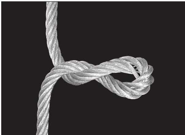
Bild 105: Diese Seil wurde im seilzudrehenden Sinn verdreht. Im unbelasteten Zustand bildet das Seil eine Schlaufe im aufdrehenden Sinn.
