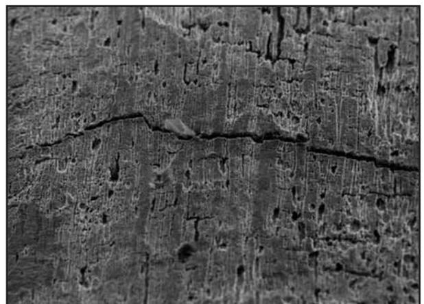
Fig. 14: Pittingbildung und Korrosion zusammen mit einem Ermdungsri (Detail von Bild 13).
