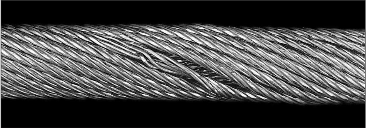
Bild 143: Eine Außenlitze ist bei ihrer Herstellung offensichtlich kurzfristig auf der Abzugs-scheibe gerutscht. Hierdurch wurde lokal eine sehr lange Schlaglänge erzeugt. Dieser Fehler wurde nicht erkannt, und die fehlerhafte Litze wurde im Seil verarbeitet.
