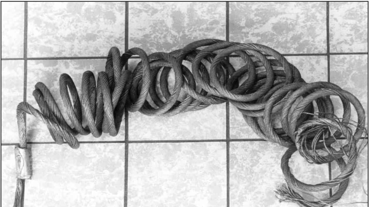
Bild 62: Drahtseile, die über eine scharfe Kante gezogen wurden, haben im entlasteten Zustand die Tendenz, sich aufzurollen.
