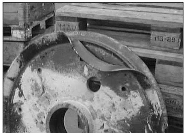
Bild 123: Starker Verschleiß kann zum Wegbrechen der Scheibenflanken führen. Die Wandstärken müssen regelmäßig gemessen werden.
