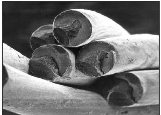
Bild 12: Nach einem Seilbruch oder einem Zerreiversuch werden oft Ermüdungsrisse an Kontaktstellen benachbarter Drhte sichtbar.
