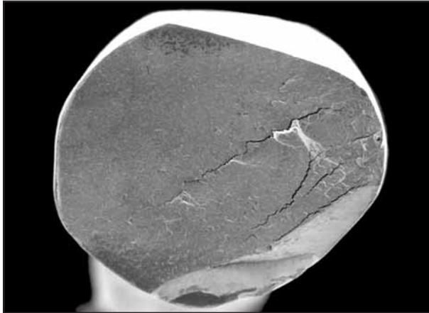
Bild 18: Ein nur wenig auf Zug beanspruchter Draht zeigt eine große Ermüdungsfläche und nur einen kleinen Restgewaltbruch.
