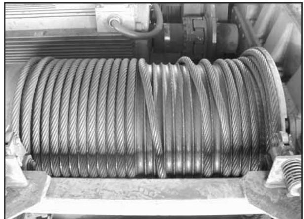
Bild 135: Seil und Trommel werden beschädigt, wenn das Seil über die Trommelstege wickelt.
