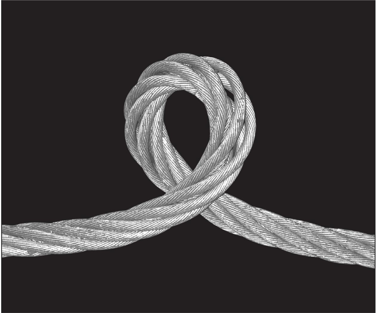
Bild 104: Dieses Seil wurde im seilaufdrehenden Sinn verdreht. Im unbelasteten Zustand bildet das Seil eine Schlaufe im seilzudrehenden Sinn. Wenn das Seil anschließend belastet wird, kann sich die Schlaufe zuziehen und das Seil bleibend verformen.
