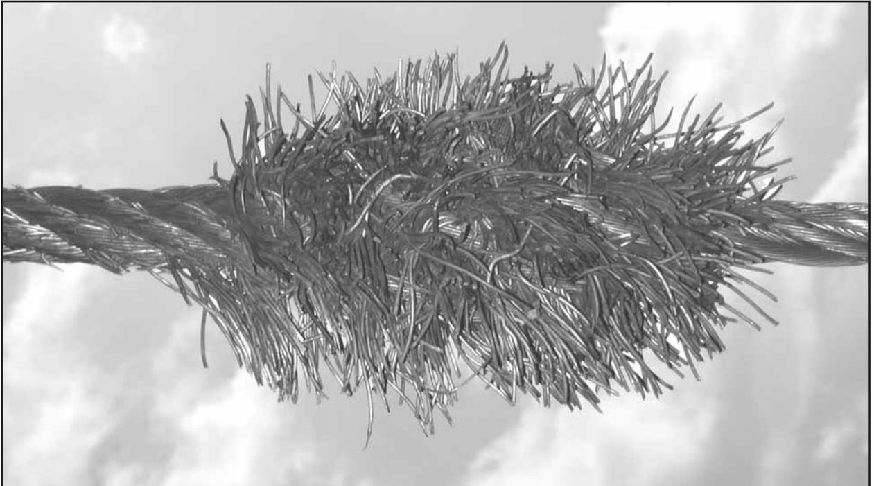
Bild 61: Schließseil eines Greiferkrans. Alle Außendrähte sind infolge von starkem Abrieb an der Austrittsdüse 1 x pro Schlaglänge gebrochen. Dann wurden die Bruchstücke zu einem Punkt hin massiert, dem Endpunkt der Bewegung.
