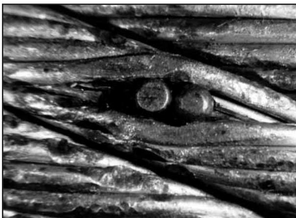
Bild 59: Ein Kran wurde, bevor er neu lackiert wurde, mit Stahlkugeln gestrahlt. Die Kugeln blieben im Schmiermittel des Seiles haften.
