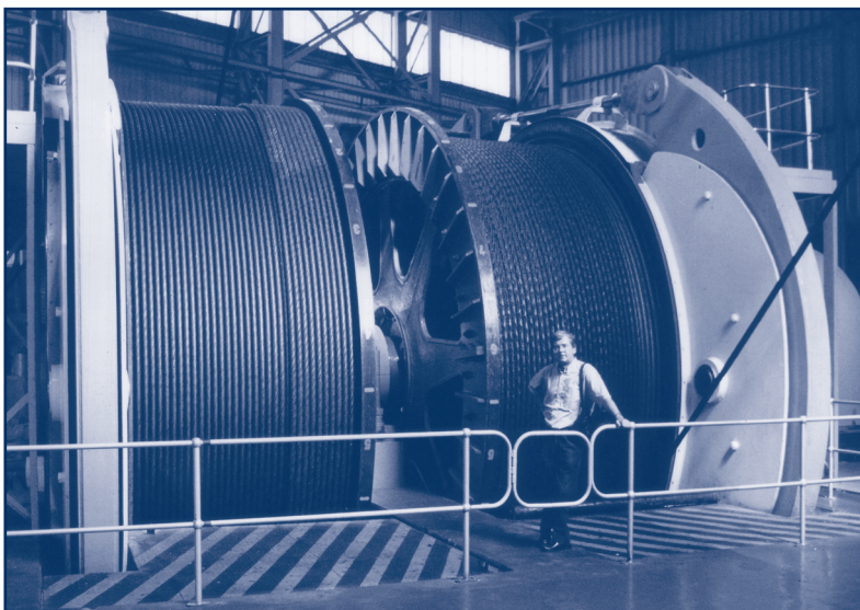
Bild 22: Im Bergbau sind D/d -Verhältnisse über 100 üblich.
