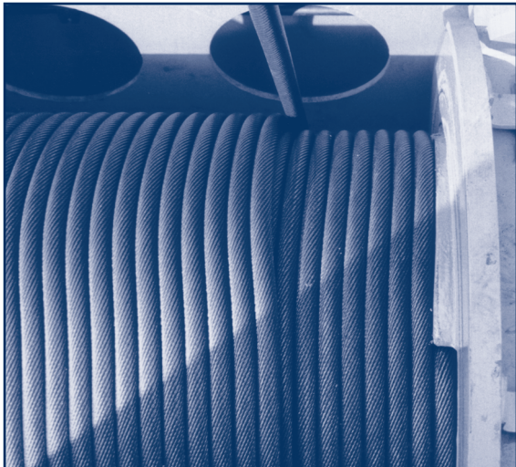
Bild 18: Lebus-Trommel. Das Seil spult im Parallelbereich
