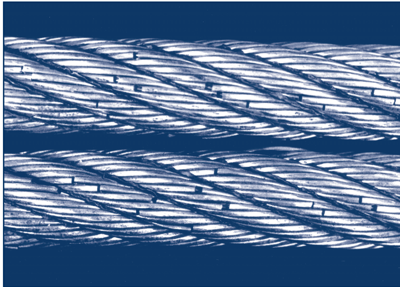
Bild 1: Drahtseile mit Ermüdungsdrahtbrüchen
