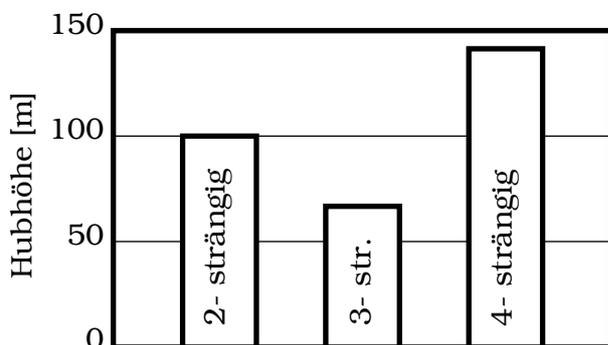
Bild 23: Einfluß der Strangzahl auf die maximal mögliche Hubhöhe
