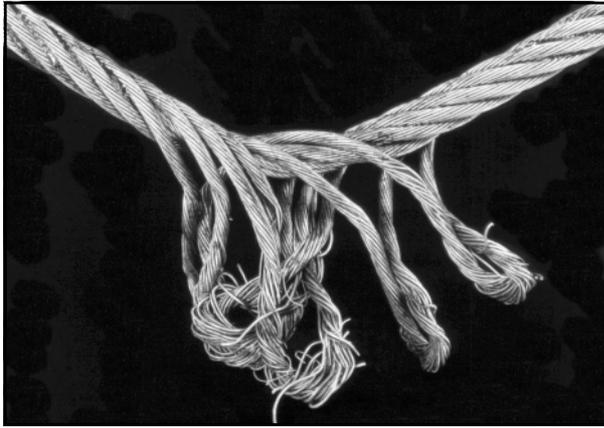
Bild 39: Längenüberschuß der Außenlitzen, verursacht durch Aufdrehen des Drahtseiles.
