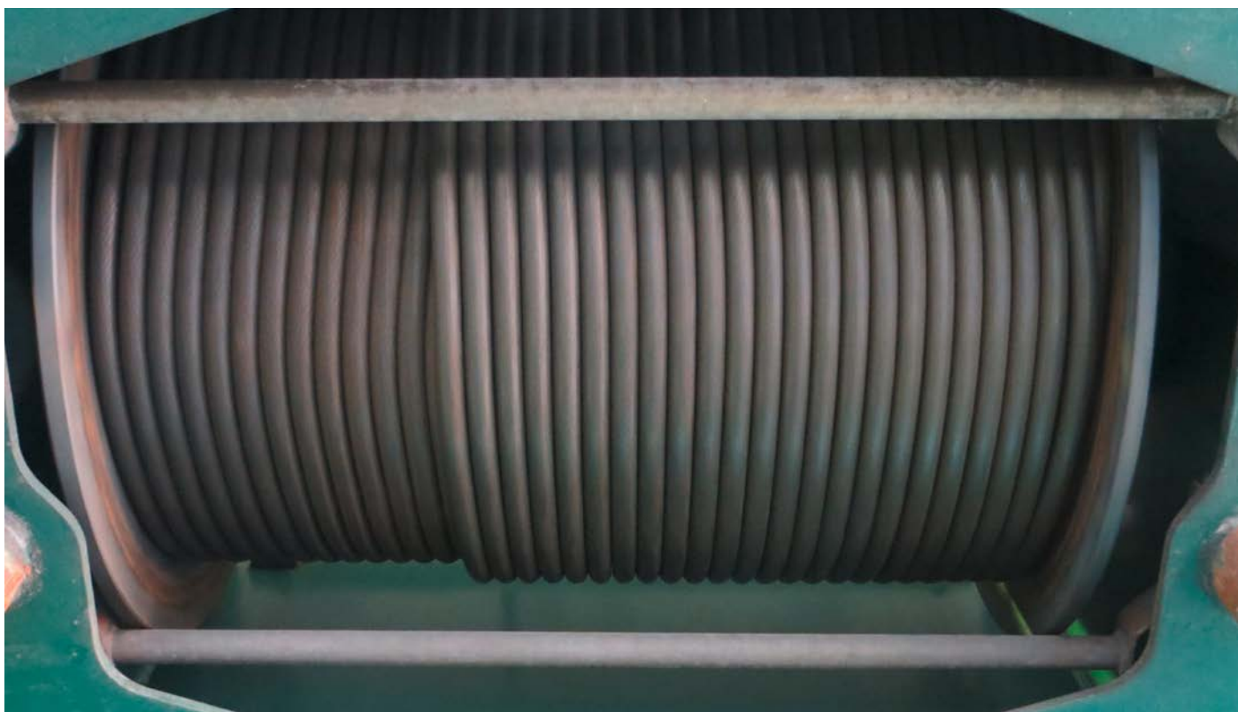
Spultest auf einem Mobilkran – Hervorragendes Spulverhalten bei Mehrlagenspulung
