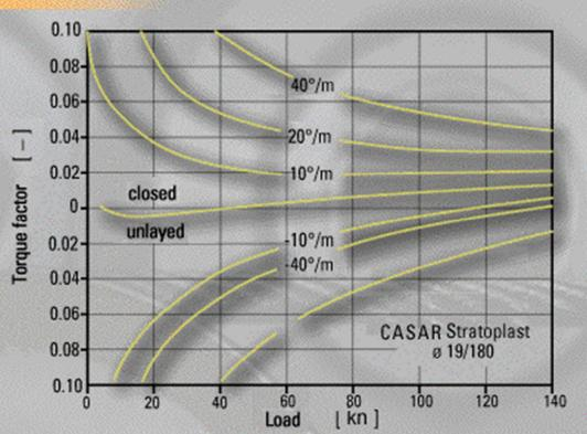
Bild 29: Veränderung des Drehmomentfaktors durch gewaltsame Verdrehung bei einem drehungsfreien Drahtseil. Der Faktor k ändert sich stark.
